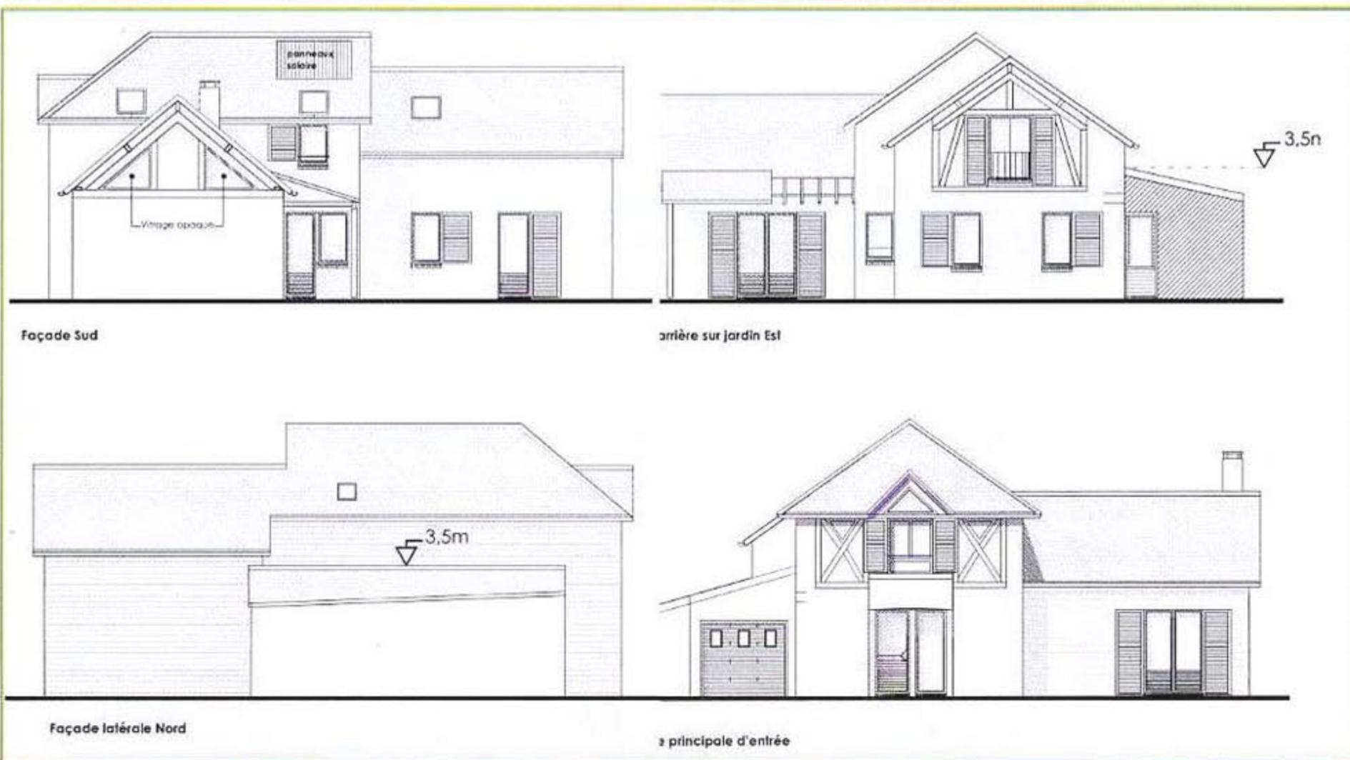
La différence de traitement des façades en fonction de leur exposition est ici flagrante. Le nord est fermé, et, derrière ces murs aveugles, on dispose les zones tampons : elles font la jonction entre les parties chauffées (placées face au sud) de la maison et celles qui ont moins besoin d'apports caloriques : garage, réserve ou cellier, sas d'entrée, buanderie et W.-C....
