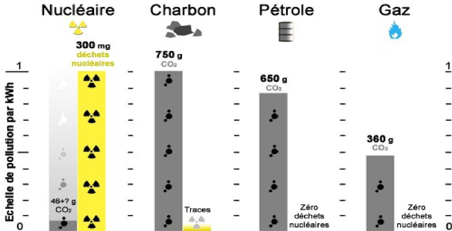
Les nouvelles centrales cycle combiné gaz (CCG), très efficaces, n'émettent "que" **360 g CO<sub>2</sub>/kWh** et peuvent accepter dès que possible **du biogaz comme combustible renouvelable** (CH<sub>4</sub> issu de la fermentation des déchets alimentaires ou agricoles) **neutre en émissions de CO<sub>2</sub>**. A l'inverse, le nucléaire n'est pas neutre en CO<sub>2</sub> (importation de l'uranium, transport et enfouissement des déchets nucléaires, etc.).
